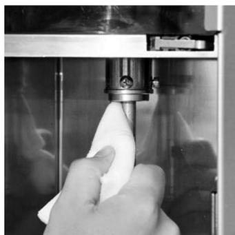
ノズルと温度センサーの隙間の清掃
