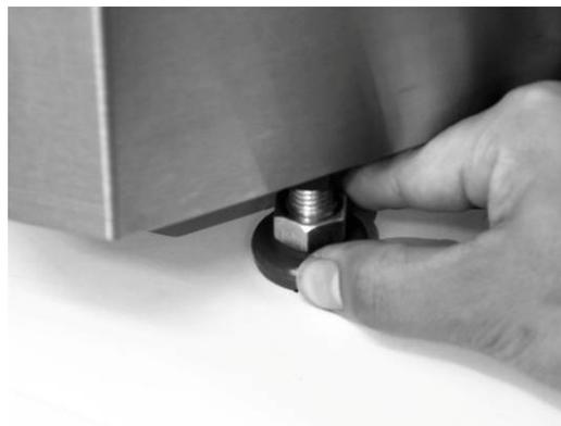
アジャスターを手で回して高さを調節後、再度ロックを締める。
