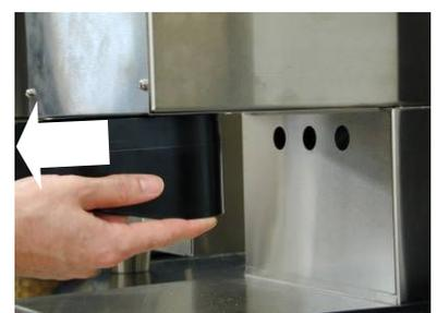
4. ファンネルをセットするところのすぐ上にある、グラインダー前面パネルのネジを2本、およびコーヒー粉出口付近にあるネジを2本の計4本のネジを外してください。
